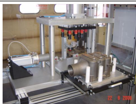
Prüfvorrichtung # 11494 in „Schubladenausführung“ für gute Zugänglichkeit
