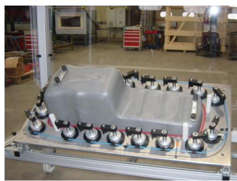
Prüfvorrichtung # 14855 in gut zugänglicher „Schräglage“ mit Pneumatikspanner
